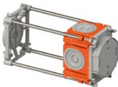
délka rozpěrných tyčí = tloušťka realizované stěny - 45 mm
